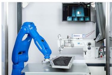
Figura 16. Robot de cusut brodat
