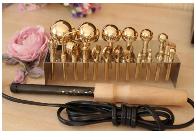
Imaginea 2. Instrumente termice utilizate la prelucrarea florilor textile
